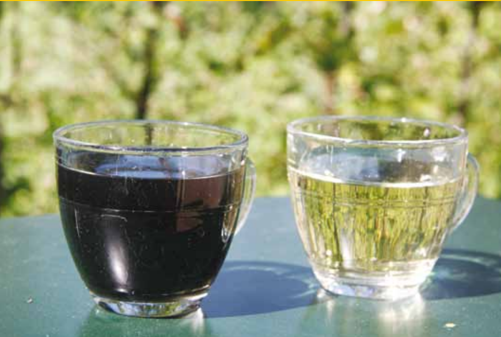
Afvalwater vòòr en nà filtering door het grasdak.
